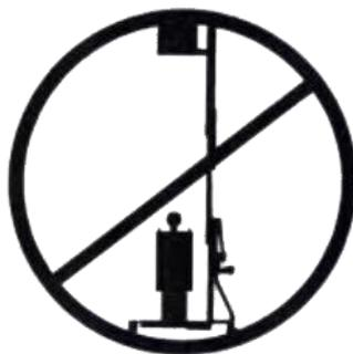
在事先没有对工作场地（包括安全距离范围内）进行检查且确认没有任何障碍物或有任何人员或其它情况禁止直接操纵升降机来起吊或降落货物。
